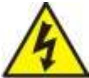
Wird auf dem Power Supply abgebildet, um auf eine Fläche mit potentieller Gefahr eines Stromschlags zu kennzeichnen. Lesen Sie das Handbuch, um mögliche Verletzungen oder Schäden am Gerät zu vermeiden.
