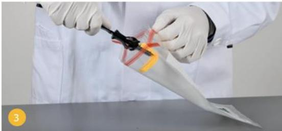
3 Den Schwamm durch Zurückziehen des Clips vom Schnell-Auslöse-Griff in den mitgelieferten Twirl-Tie™ Probenbeutel abwerfen.
