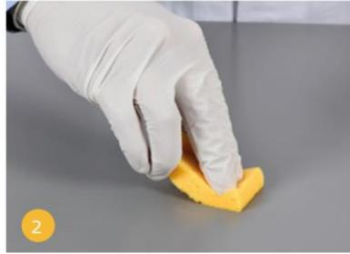
Probenahme durch kräftiges Wischen des Schwamms auf der Testfläche (z.B.: 30 x 30 cm).
