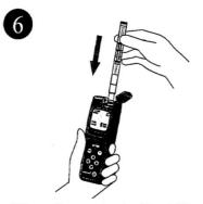
Führen Sie nun den LuciPac A3 in die Messkammer des Lumitesters ein und schließen Sie den Deckel
