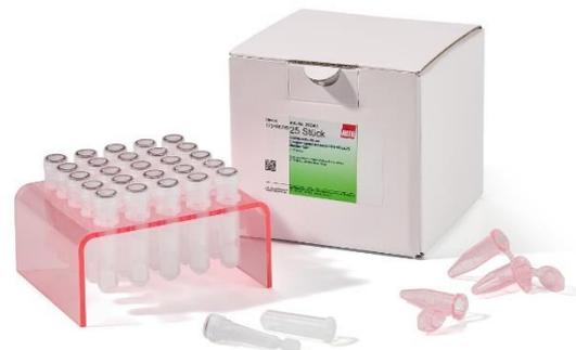
Die vorgepackten ROTI®Dex-Zentrifugationssäulen dienen zur Aufreinigung und Entsalzung kleiner Probevolumina (optimal 50 µl) in weniger als 5 Minuten.
