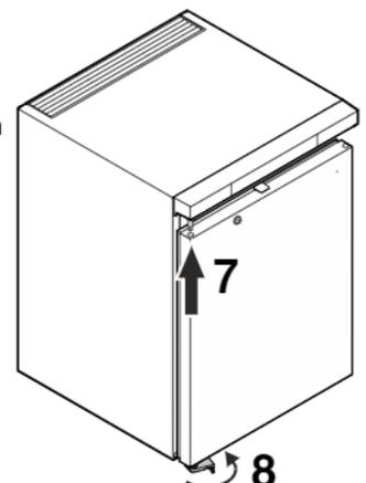
8. Scharnierwinkel in unteres Türlagereinsetzen. Scharnierwinkel um 90° drehen - Feder wird gespannt. Scharnierwinkel anschrauben.
