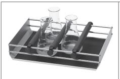
Mit den Spannleisten h können problemlos alle Gefäße mit flachem Boden (Erlenmeyerkolben, Bechergläser, Reagenzglasgestelle, Analysensiebe etc.) auf den Schüttlern fixiert werden. Zur Ergänzung der vorhandenen Leisten.
