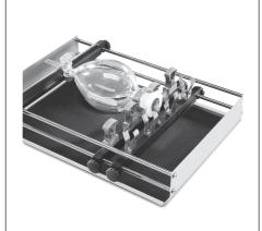
Die Klammer- und Federleisten werden benötigt, um Scheidetrichter einzuspannen. Dabei werden die Schliffhälse der Scheidetrichter in den grauen Kunststoffklammern befestigt, mit der Federleiste werden die Schliff-Stopfen gesichert. Die Auslaufspitze des Scheidetrichters wird auf einer Spannleiste h aufgelegt. Zur Modifizierung des Standardaufsatzes oder als Ergänzung der vorhandenen Leisten auch einzeln lieferbar.
