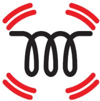
Heiz-Kontrollleuchte: Durch Dauerlicht oder Blinken wird angezeigt, dass den Heizelementen Strom zugeführt wird.
