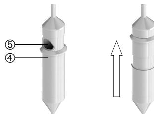
2. На необходимой глубине потяните устройство примерно на 10 см назад. Таким образом подвижная муфта откроет отверстие для заполнения.
