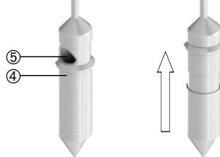
2. In gewünschter Tiefe das Gerät ca. 10 cm zurückziehen. Hierdurch öffnet die Verschlusshülse die Einfüllöffnung.
