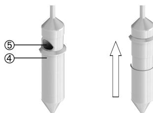
2. A la profondeur souhaitée, retirer le préleveur d'environ 10 cm. Ce faisant, le clapet d'opturation ouvre l'aperture de remplissage.
