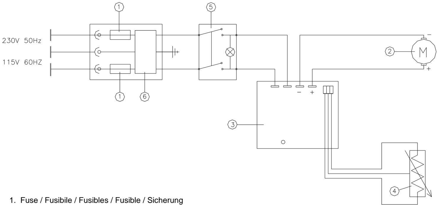
1. Fuse / Fusibile / Fusibles / Fusible / Sicherung
