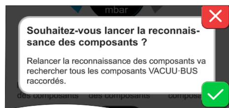
La **détection des composants** scanne tous composants raccordés et met la liste des périphériques VACUU·BUS raccordés à jour. Exemple: En débranchant un capteur de niveau et effectuant la détection des composants, le capteur de niveau n'est plus listé dans la configuration des composants.
