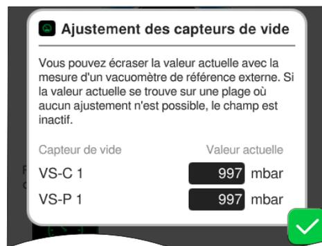
Fenêtre d'**ajustement des capteurs de vide** raccordés, à la pression ambiante ou sous vide.
