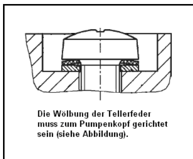
Abb. 6: Ausrichtung der Tellerfeder
