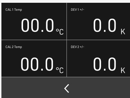
CAL1Temp für die Einstellung der Abgleichtemperatur CAL1 anwählen
