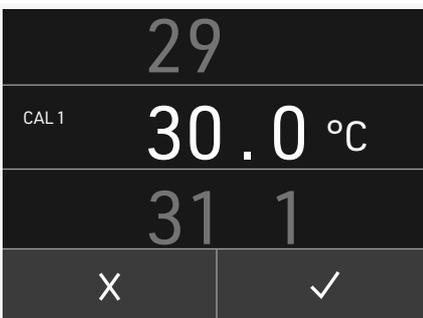
Über vertikales Scrollen die Abgleichtemperatur CAL1 auf 30°C einstellen
