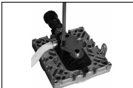
Spannpratzen auf den Ventilinseln lösen.
