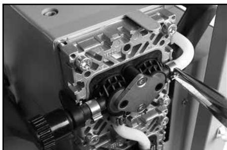
Schlauchverbindung des Verbindungsschlauchs zur anderen Pumpenseite wieder herstellen.
