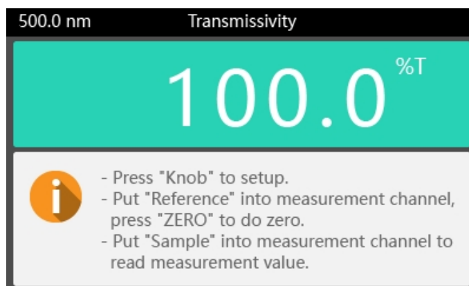
Fig. 6-3 Mesure de la transmissivité
