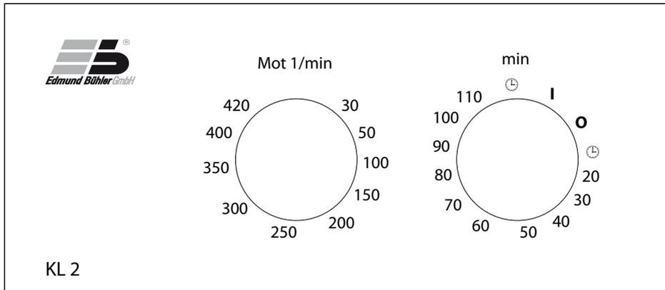
Le tableau de commande des agitateurs ci-dessus a deux boutons de réglage. Régler la fréquence d'agitation désirée au bouton gauche (vitesse: voir données techniques).
