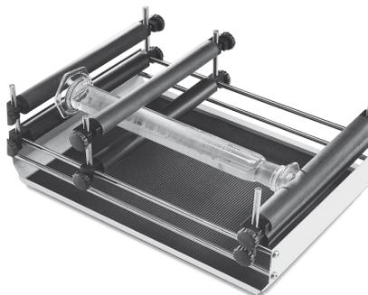
Tringle de serrage v : en combinaison avec les tringles de serrage h, pour bien fixer des récipients hauts (p. ex. des bouteilles, béchers, cylindres, etc.) ou des cylindres horizontaux. La distance maximale est 60 mm. Pour compléter les tringles existants.
