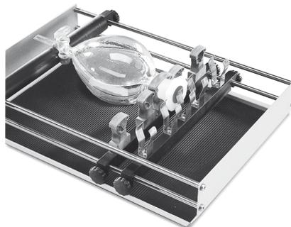
Les tringles support et les tringles à ressort sont spécialement pour la fixation des ampoules de décantation. On fixe les goulots avec les pinces gris, les bouchons sont pressés sur les ampoules par le tringle à ressort. Le bout est appuyé sur le tringle de serrage h. Pour la modification de la plateforme standard ou en complément des tringles de serrage existants.
