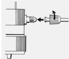
Vissez le set de la canule de refoulement sur le bloc souape. Enlevez le capuchon de fermeture.
