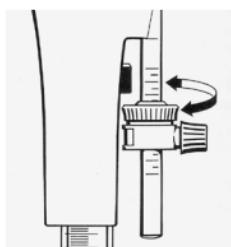
Pour la calibration du volume avec une balance analytique, utilisez l'écrou du système de réglage fin, le déplacer vers le bas, ce qui augmentera le volume. Le déplacer vers le haut, diminuera le volume délivré.
