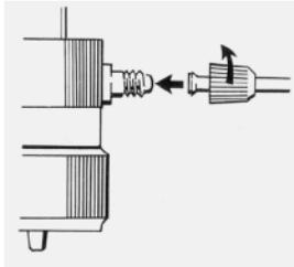
Dosierkanülen-Set auf die Kanülenaufnahme des Ventilblocks aufschrauben. Verschlusskappe von der Dosierkanüle abziehen.
