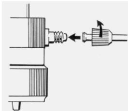
Avvitare il kit cannula dosatrice sul supporto cannula dosatrice del blocco valvole. Togliere il tappetto dalla cannula dosatrice.
