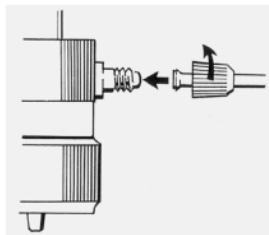
排液套管拧在阀门模块上, 揭开安全盖。
