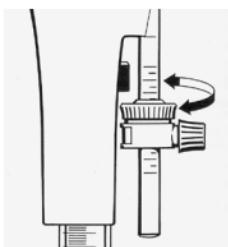
Zur genauen Feinabstimmung des gewünschten Volumens über eine Analysenwaage die Feinjustier-Mutter drehen. Nach unten drehen bedeutet größeres Volumen, nach oben drehen bedeutet kleineres Volumen.
