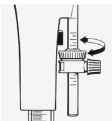
Per la registrazione di precisione del volume richiesto, ruotare il dado di registrazione di precisione sopra ad una bilancia per analisi. Ruotando verso il basso, il volume aumenta, verso l'alto il volume viene ridotto.
