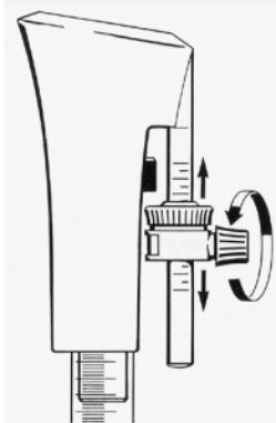
Per disaerare l'apparecchio sollevare leggermente più volte lo stantuffo dosatore ed effettuare la dosatura fino a quando nel cilindro dosatore non si vedono più bolle d'aria. Modello HF: Sollevare più volte leggermente lo stantuffo e dosare per riempire il sistema di canali.
