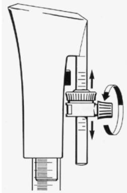
Zum Entlüften des Geräts mehrmals den Dosierkolben wenig anheben und dosieren bis keine Luftblasen mehr im Dosierzylinder zu sehen sind.
