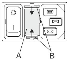
Le porte-fusible (A) avec les fusibles d'entrée de secteur se trouve à côté de l'interrupteur secteur.
