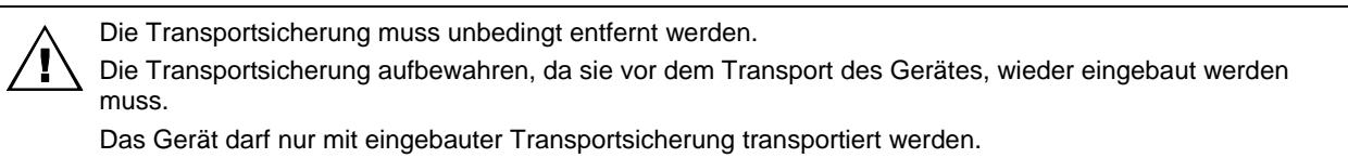
Um das Gerät während des Transports vor Beschädigungen zu schützen, wird der Motor fixiert. Diese Transportsicherung muss bei der Inbetriebnahme des Gerätes entfernt werden.
