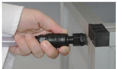
Bitte beachten Sie: Gase zur Überlagerung, welche schwerer sind als Luft (Dichte = 1,2041 kg/m<sup>3</sup>), müssen unten eingeleitet werden. Gase, welche leichter sind als Luft, müssen oben eingeleitet werden.
