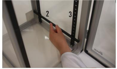
» Schieben Sie einen Einlegeboden (4) in die Führungsschienen (2) hinein.
