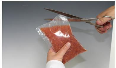
» Lassen Sie das Trocknungsmittel aus geringer Höhe in die mitgelieferte Bodenwanne rieseln. Das Trocknungsmittel kann sofort eingesetzt werden.
