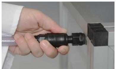
Veillez noter: Il faut d'introduire de haute les gaz dont la densité est plus petite que la densité de l'air (densité = 1,2929 kg/m<sup>3</sup>). Les gaz dont la densité est plus grande que la densité de l'air sont à introduire de bas.
