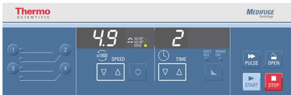
RZB steht für Relative Zentrifugalbeschleunigung und erlaubt eine bessere Übergabe von Protokollen zwischen Zentrifugen und Rotoren unterschiedlicher Größe.
