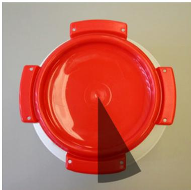
2. Nehmen Sie ein Werkzeug und mit Hilfe davon drehen Sie den Deckel noch einmal um 30 Grad. Danach ist das Fass Flüssigkeitsdicht geschlossen und die UN-Kennzeichnung ist gültig.
