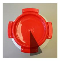
2. Faire pivoter le couvercle à 30° le sens des aiguilles d'une montre à l'aide d'un outil. Maintenant seulement le fût est hermétique et le marquage UN est valide.
