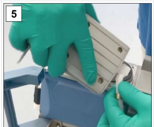
4. Legen Sie die neuen Ventile auf und richten Sie diese aus; Dichtungssatz MD 1C.
