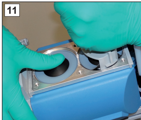
11. Vissez le module fermement à l'aide de la clé pour les membranes.
