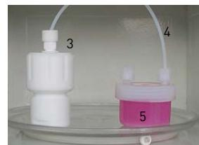
» **Tipp:** Schläuche können durch die Fertigungstoleranz im Außen-durchmesser variieren – der Schlauch lässt sich dadurch manchmal nicht hineinschieben. So kann es nötig sein, die Bauteile der Ver-schraubung einzeln auf den Schlauch aufzuschieben und zu montieren. Beachten Sie hierbei unbedingt die Reihenfolge und die Lage des Dichtkeils (6) und des Klemmkeils (7).
