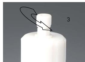
» Schieben Sie den Schlauch (4) bis zum Anschlag in die Mutter (3) hinein.
