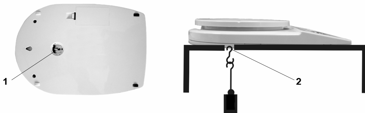
Fig. 1 : Disposition de la balance pour le pesage par en dessous.
