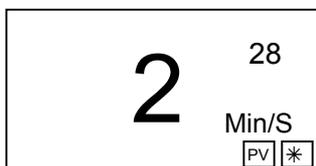
L'agitateur démarre, le symbole „PV“ (Process Value) est affiché. Quand le temps est déroulé, l'appareil arrête automatiquement. Le symbole „SV“ clignote.
