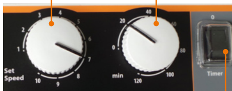
Umschalter Dauerbetrieb / „Timer“
