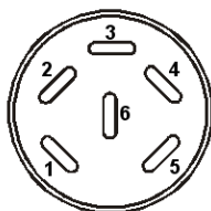
Figure 22: Affectation des pins de la douille DIN
