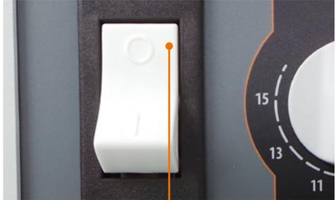
EIN-/AUS-Schalter: Gerät ausgeschaltet
