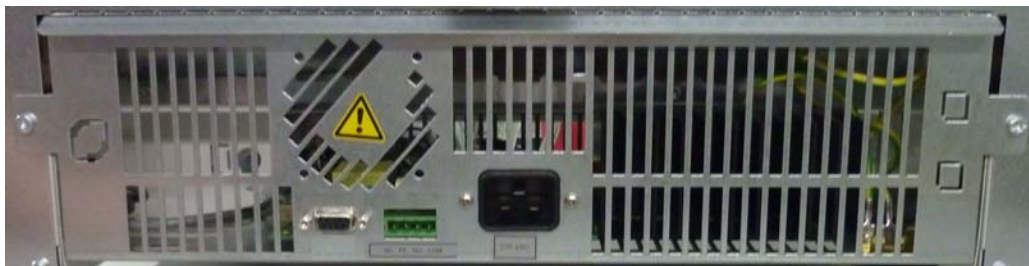
Abbildung 4-11 Signalschnittstellen und Netzanschluss
