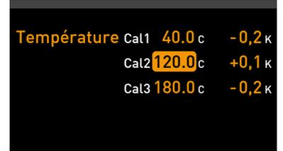
4. Appuyer sur la touche de validation pour enregistrer le réglage. La valeur corrective d'étalonnage correspondante est automatiquement indiquée.
