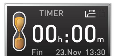
Pour désactiver le programmateur, appuyer sur la touche de validation pour appeler de nouveau l'affichage du programmateur, ramener la durée du cycle à l'aide du bouton rotateur jusqu'à l'affichage --:-- et accepter avec la touche de validation.
