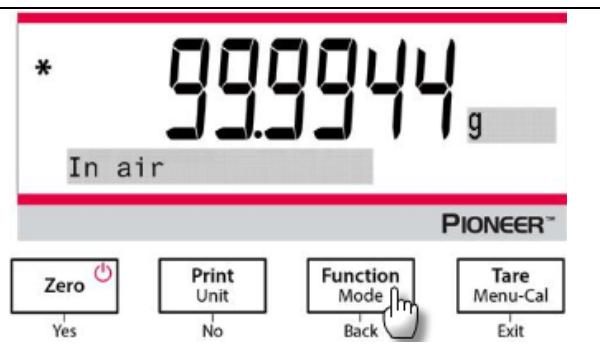
2. Wiegen Sie den kalibrierten Senkkörper, der mit der Waage und dem Dichtebestimmungskit in die Flüssigkeit eingetaucht wird. Senken Sie den kalibrierten Senkkörper in die Flüssigkeit ab, bis er vollständig eingetaucht ist (1 cm unter der Oberfläche der Flüssigkeit).
