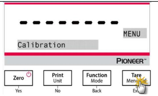
2. Premere “**YES**” (Si) per accedere al Menu Taratura. Per variare la modalità di taratura, premere **NO** finché “Span Cal” (taratura di portata) viene visualizzata.
