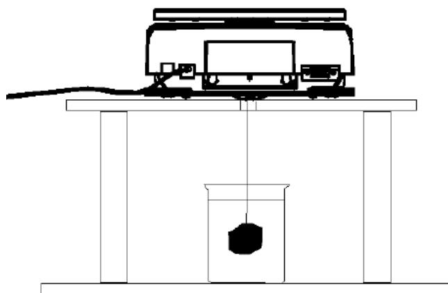
Prima di rovesciare la bilancia, rimuovere la piastra della bilancia e gli elementi scudo del paravento (se presenti) per evitare danneggiamenti. Non porre la bilancia sul supporto conico della piastra della bilancia o sui perni delle celle di carico.
