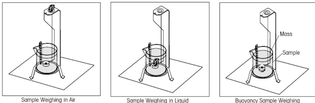
Legen Sie den Festkörper in die Wiegeschale auf dem Wiegehaken in der Flüssigkeit wie gezeigt. Stellen Sie sicher, dass sich keine Luftblasen auf dem zu wiegenden Körper befinden. Schließen Sie die Windschutztüren und wiegen Sie den Festkörper (Auftrieb P). Das Display zeigt die Dichte in Gramm/cc an.
