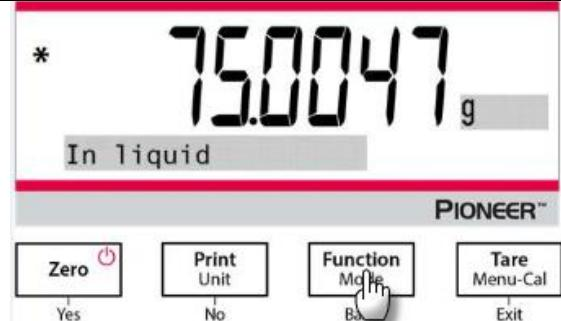
3. Pulse el botón **Function / Mode** para obtener la densidad de la muestra. Una vez finalizada la prueba, pulse el botón **Function / Mode** para realizar el análisis de una nueva muestra.
