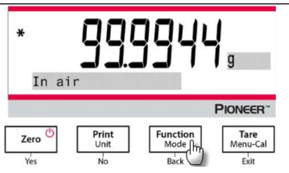
2. Peser le plomb calibré submergé dans le liquide en utilisant la balance et le kit de détermination de la densité. Rabaisser le plomb calibré dans le liquide jusqu'à ce qu'il soit entièrement submergé. (1 cm en dessous de la surface du liquide).
