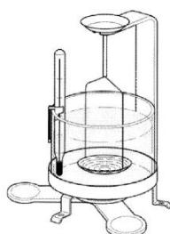
Bei der Dichtemessung sollte das Material mindestens 10,0 mg auf einer Analysenwaage und 100 mg auf einer Präzisionswaage wiegen.
