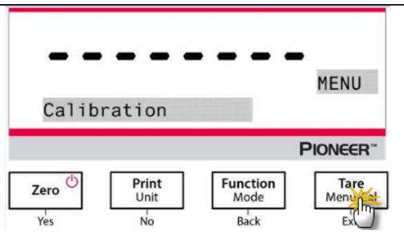
2. Pulse **Yes** para entrar en el menú de calibración. Para cambiar el modo de calibración, pulse **No** hasta que aparezca «Linearity Cal» (calibración de linealidad) en la pantalla.
