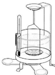
Lors des mesures de densité, le matériel doit peser au moins 10,0 mg sur une balance analytique et 100 mg sur une balance de précision.
