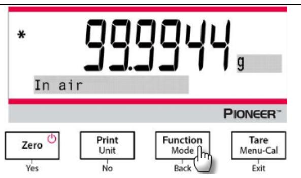
2. Pese el plomo calibrado sumergido en el líquido, utilizando la balanza y el kit de determinación de densidad. Introduzca el plomo calibrado en el líquido hasta que esté completamente sumergido (1 cm por debajo de la superficie del líquido).
