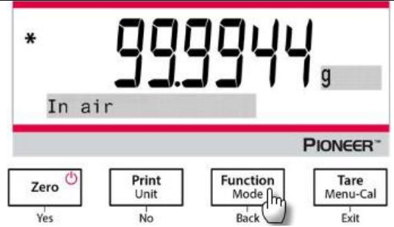
2. Peser l'échantillon submersé en utilisant la balance et le kit de détermination de la densité.
