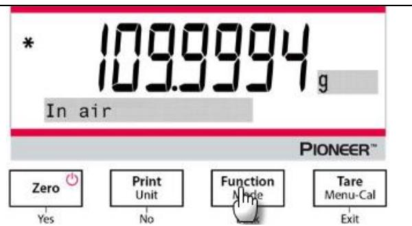
3. Pesare il campione lubrificato nel liquido con la bilancia e il kit di determinazione della densità.
