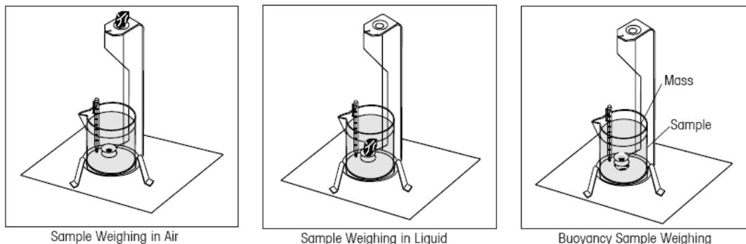
Placer le liquide dans un plateau de pesage sur le poids en bas du crochet dans le liquide tel qu'indiqué. S'assurer qu'il n'y a pas de bulles d'air sur le liquide à peser.
