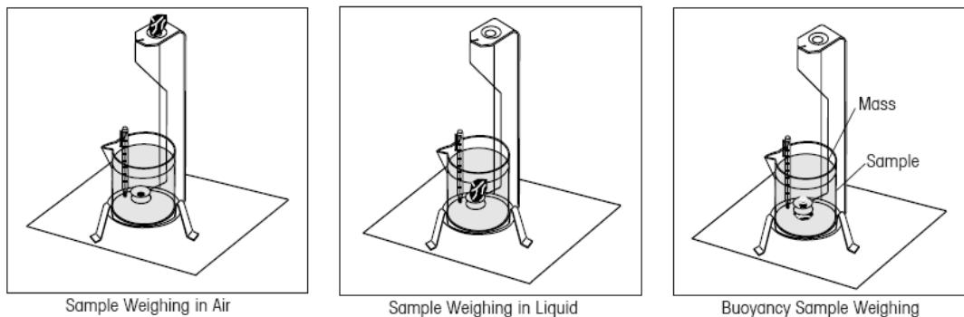
Coloque el sólido en el plato de pesaje en el gancho de pesaje por debajo dentro del líquido como se muestra. Asegúrese de que el sólido que va a pesar no tenga burbujas.
