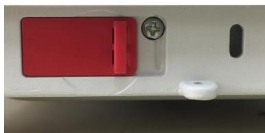
**Remarque:** Le commutateur est également utilisé en conjonction avec le légal pour l'élément du menu de commerce. Lorsque le légal pour le menu de commerce est réglé à MARCHE, le commutateur doit être réglé à la position Marche pour empêcher le calibrage et les changements aux réglages métrologiques significatifs.
