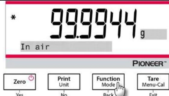
2. Pese la muestra sumergida en el líquido, utilizando la balanza y el kit de determinación de densidad.
