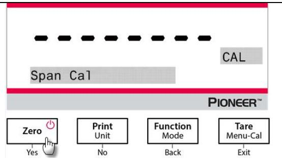
4. Il valore delle masse di taratura verrà mostrato sullo schermo. Dopo che il display “Place weights” (Porre pesi) e “100,0000 g”, porre il peso(i) di 100 g sulla piastra della bilancia per la taratura. Per passare al punto di taratura di metà capacità (ad esempio 50 g), premere il pulsante **Funzione/Modalità**. Dopo che lo schermo mostra “Place weights” (Porre pesi) e “50,000 g”, porre un peso(i) di 50 g sulla piastra della bilancia per la taratura.
