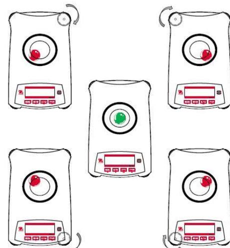
Figure 2-1. Nivellement
