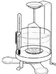
Al hacer mediciones de densidad, el material debe pesar por lo menos 10,0 mg en una balanza analítica y 100 mg en una balanza de precisión.
