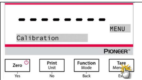
2. Appuyer sur **Yes** pour entrer dans le menu de calibrage. Pour changer le mode de calibrage, appuyer sur **No** jusqu'à ce que Cal de linéarité (calibrage de linéarité) s'affiche.
