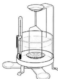
Quando si effettuano misurazioni di densità, il materiale deve pesare almeno 10,0 mg su una bilancia analitica e 100 mg su un bilanciamento di precisione.
