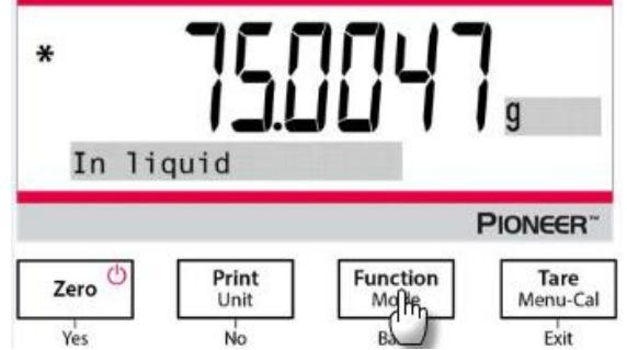
3. Appuyer sur le bouton **Function / Mode** pour obtenir la densité de l'échantillon. Après avoir terminé le test, appuyer sur le bouton **Function / Mode** pour tester un nouvel échantillon.
