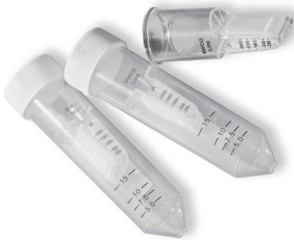
Unsere ROTI®Spin Zentrifugationsfiltereinheiten sind für die einfache und effiziente Konzentration und Dialyse von Biomolekülen optimiert. Die neutral geladene Polyethersulfon (PES)-Membran hat eine breite chemische Kompatibilität und eine ausgezeichnete chemische Beständigkeit. Die Membran wurde durch ein spezielles Verfahren bindungsminimiert, um besonders hohe Recovery-Raten zu erzielen. Um ein Austrocknen der Probe zu verhindern, sind die Zentrifugalfilter mit einem Totvolumen ausgestattet.
