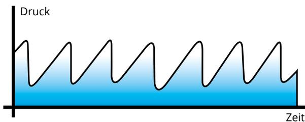
Der VACUU·SELECT Vakuumregler regelt das Vakuum über die klassische Methode der Zweipunktregelung durch Öffnen und Schließen eines Saugleitungsventils. Die Hysterese, also den Druckunterschied zwischen den zwei Punkten zum Öffnen und Schließen des Magnetventils, optimiert der VACUU·SELECT selbstständig. Die bei Ventilsteuerungen unvermeidbaren Druckschwankungen werden minimiert. Bei Verdampfungsprozessen werden die Siedepunkte ohne Benutzervorgaben erkannt.
