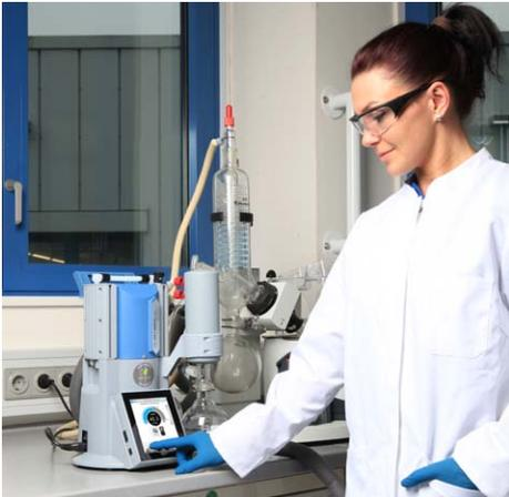
Der Modus „Automatische Verdampfung“ eignet sich perfekt für Anwendungen am Rotationsverdampfer. Sie betätigen einfach nur die Starttaste, der Siededruck wird automatisch angesteuert und dem Verlauf der Verdampfung optimal angepasst. Der Prozess läuft schnell und ohne Übersäumen ab. Manuelles Nachregeln und das Überwachen der Anwendung entfallen komplett.
