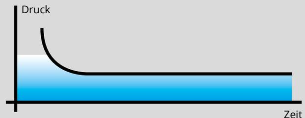
VARIO Chemie-Membranpumpen und Chemie-Pumpstände mit VACUU·SELECT regeln das Vakuum punktgenau und damit hysteresefrei durch Anpassen der Drehzahl der Membranpumpe. Die schnelle, präzise Regelung stellt immer das optimale Saugvermögen bereit, unabhängig von Dampfmenge und Größe der Apparatur. Der Prozess befindet sich immer im optimalen Betriebsvakuum – das führt zu kürzesten Prozesszeiten.
