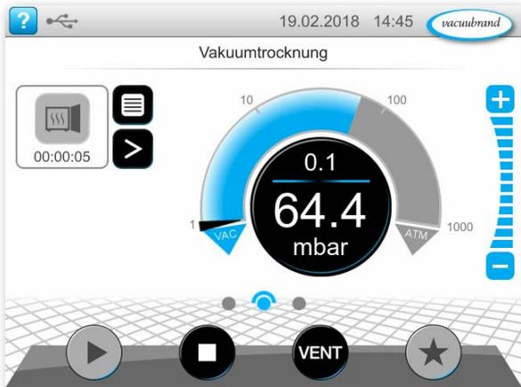
Die Bedienung des VACUU-SELECT orientiert sich an modernen Smartphones. Die interaktive Menüführung ist gezielt auf die Anwendungen im Labor ausgelegt. Die richtigen Einstellungen zur Vakuumregelung gehen schnell und einfach von der Hand.
