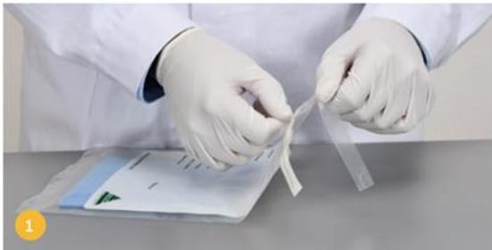
Twirl-Tie™ Probenbeutel öffnen und Textiltuch entnehmen. Bei der Probennahme sind die ganze Zeit Handschuhe zu tragen.
