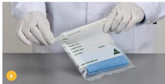
Den Twirl-Tie™ Probenbeutel mit Hilfe der Drähte dicht verschließen.
