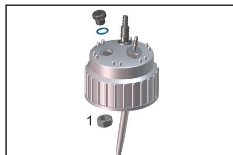
**Seulement BVC avec flacon polypropylène:** Détachez le contre-écrou dans le bouchon fileté.
