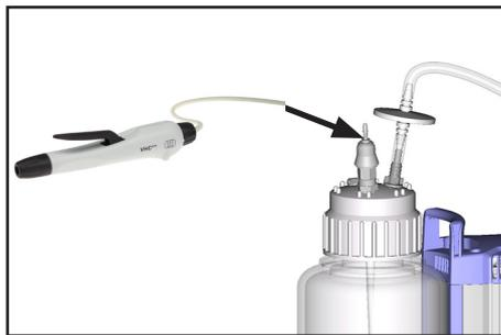
Connectez le tuyau du VacuuHandControl VHC<sup>pro</sup> à l'embout du bouchon fileté.
